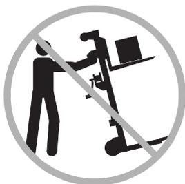
Abgesehen von geringfügigen Positionsänderungen darf die Maschine mit angehobener Last nicht bewegt werden.
