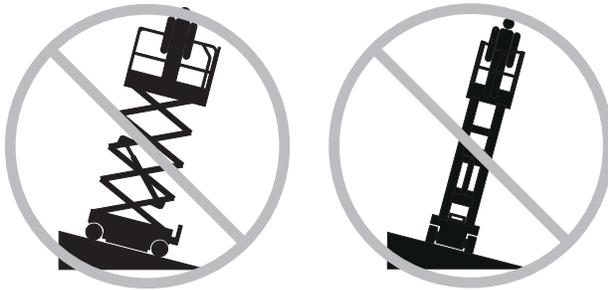
Überprüfen Sie, ob die Maschine waagrecht steht, und verlassen Sie sich nicht auf den Neigungsalarm. Der Neigungsalarm am Fahrgestell ertönt, wenn die Maschine auf abschüssigem Gelände steht.
