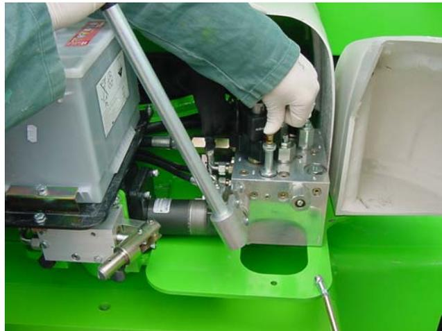
Den Handpumpengriff an der Pumpe des Antriebsreguliertventils anbringen. Das Stellglied zum Lösen der Bremse drücken und halten, während der Griff zum Pumpen verwendet wird. Wenn der Bremsdruck erzeugt wird, ist das aus der Bremsanzeige ersichtlich, die aus dem Gehäuse ‚herausspringt‘.
