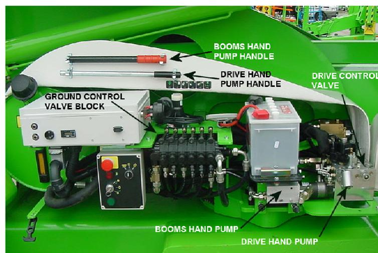
In erster Linie gibt es zwei Nothandpumpen, d. h. eine nur für die Auslegerfunktionen, die separat und neben dem Ventilblock der Steuervorrichtungen am Bodenbedienungsstand angebracht ist, und eine zweite Handpumpe, die speziell dem Antriebssystem dient und mit dem Antriebsreguliertventil verbunden ist.
