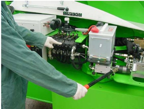
Auf Wunsch kann der Bediener des Arbeitskorbs den entsprechenden Hebel zum Manövrieren der Maschine halten, während ein Arbeiter am Boden durch Verwendung der Nothandpumpe die Triebkraft bereitstellt. Wenn der Hebel nicht in Verwendung ist, muss er wieder in seinen Klemmen verstaut werden.
